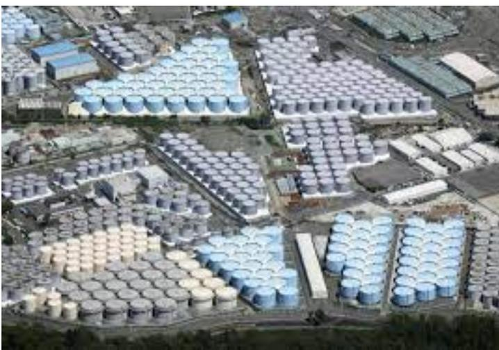
Vue aérienne des réservoirs d'eau irradiée stockée depuis 2011 autour de la centrale dévastée de Fukushima. La saturation de l'espace occupé par ces réservoirs est visible.
